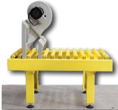
Soğuk hava fanlı avare ilave. Idle roller conveyor with an air fan.
